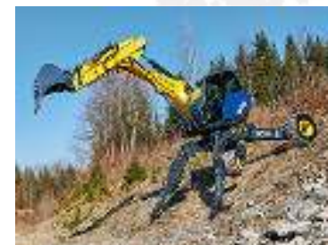
Exemple de pelleteuse adaptée au travail en pente forte
